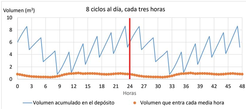
**Figura 5.7. Distribución de volúmenes a lo largo del día, durante dos días, y volumen acumulado en el depósito suponiendo distintos ocho ciclos al día. Simulación asumiendo que el funcionamiento de llenado y vaciado es por gravedad y bombeo (llenado por gravedad y vaciado mediante bombeo) y que el volumen de resguardo es de 6 m<sup>3</sup>.**
