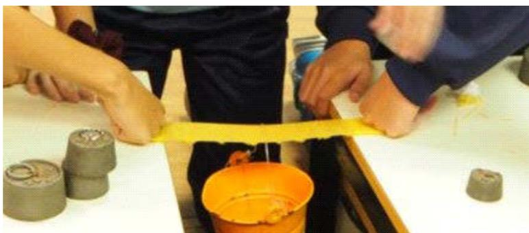
Fig. 9. Aplicación de una fuerza vertical en los apoyos para absorber por rozamiento la reacción horizontal en los apoyos.
