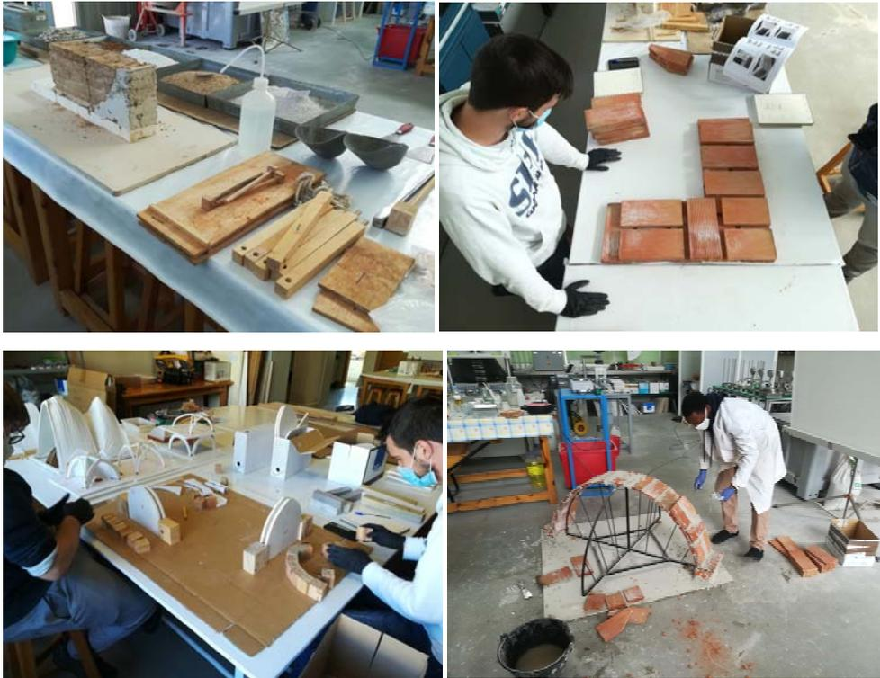
Fig. 4 a) construcción de tapial (1:5) b) aparejos de ladrillo (1:1) c) construcción de arcos (1:10) d) construcción de bóvedas (1:2)
