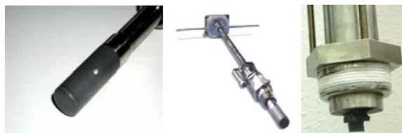
FIGURA 15. SONDAS DE INSERCIÓN ELECTROMAGNÉTICAS Y DE TURBINA.
