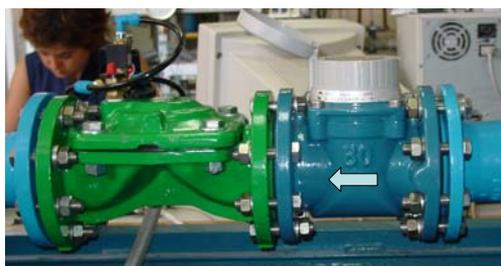
FIGURA 35. INSTALACIÓN TÍPICA DE UN HIDRANTE DE RIEGO.
