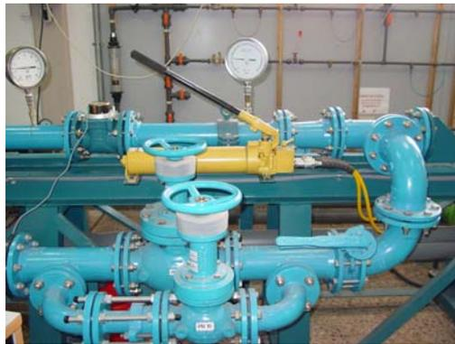
FIGURA 8. VÁLVULAS DE REGULACIÓN DE LOS CAUDALES DE ENSAYO.
