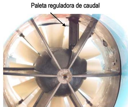
FIGURA 33. PALETA REGULADORA DE CAUDAL EN UN WOLTMAN DE EJE HORIZONTAL.
