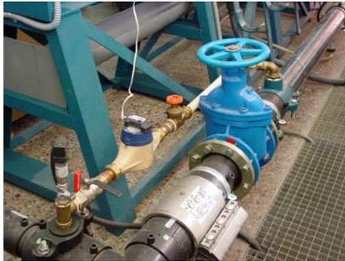
FIGURA 3. CIRCUITO EN BY-PASS PARA CAUDALES BAJOS CON CONTADOR VOLUMÉTRICO DE PRECISIÓN.
