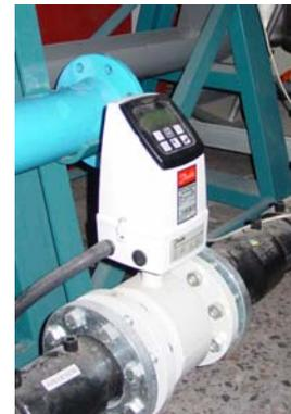
FIGURA 5. CAUDALÍMETRO ELECTROMAGNÉTICO DE REFERENCIA.
