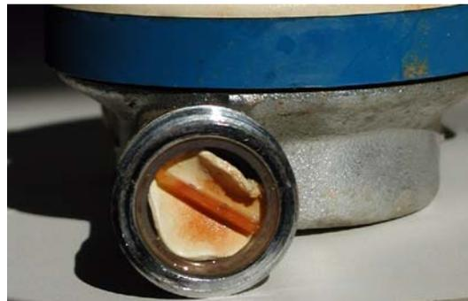
FIGURA 4. INTENTO DE MANIPULACIÓN INFRUCTUOSA: OBTURACIÓN DE LA TOBERA DE SALIDA.
