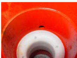
FIGURA 54. PARTE INTERNA DEL CONTADOR PROPORCIONAL. CIRCUITO PRIMARIO CON TOBERA Y ENTRADA DEL CIRCUITO SECUNDARIO.
