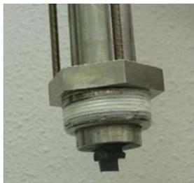
FIGURA 25. SONDA DE INSERCIÓN DE TURBINA
