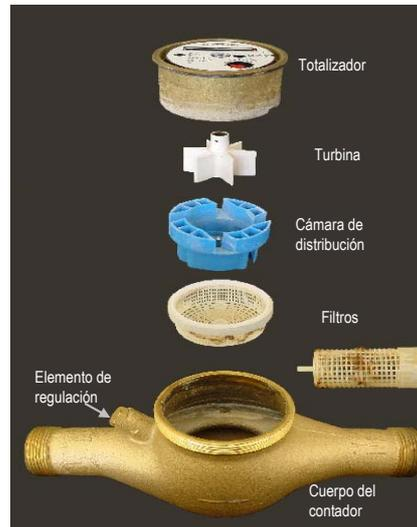
FIGURA 9. DESPIECE DE UN CONTADOR DE CHORRO MÚLTIPLE.
