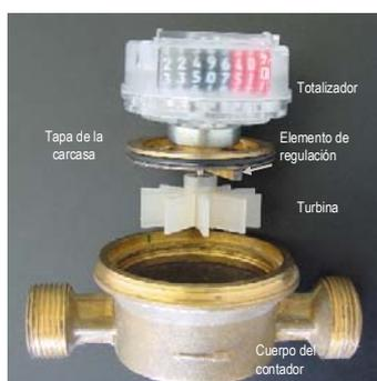
FIGURA 6. DESPIECE DE UN CONTADOR DE CHORRO ÚNICO.
