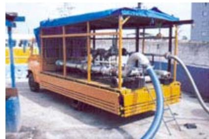
FIGURA 11. CAUDALÍMETRO DE REFERENCIA PORTÁTIL.
