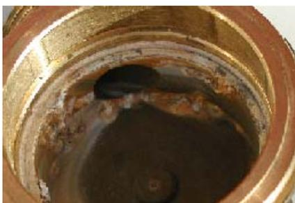
FIGURA 5. DEPOSICIONES CALCÁREAS EN EL CUERPO DEL CONTADOR DE AGUA.
