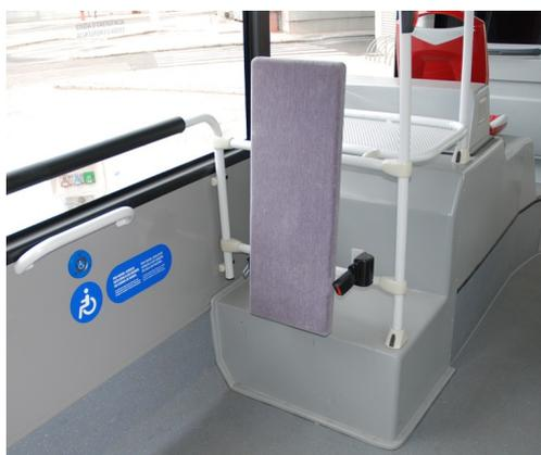
FIGURA 38. RESPALDO PARA PMR CON CINTURÓN DE SEGURIDAD EN UN AUTOBÚS DE LA EMT VALENCIA.
