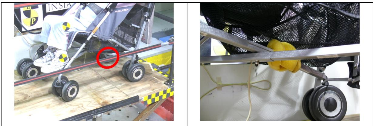
TABLA 30. SITUACIÓN DEL ACELERÓMETRO EN EL CARRITO MARCA "B" MODELO "B"
