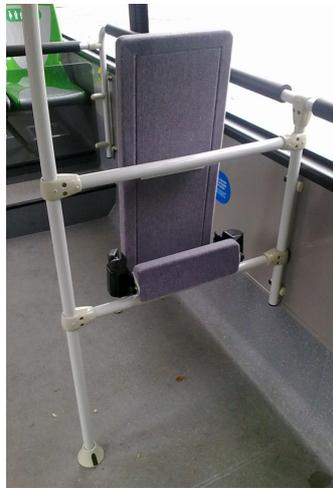
FIGURA 39. RESPALDO INSTALADO EN LA ZONA 3 DE UN AUTOBÚS DE LA EMT VALENCIA.
