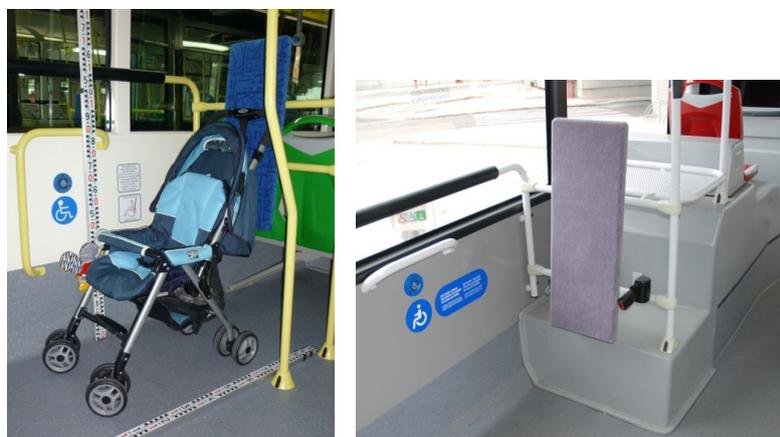
FIGURA 63. CONFIGURACIÓN PARA EL TRANSPORTE DE UN CARRITO DE NIÑO CUANDO ESTÁ DESPLEGADO EN LA ZONA RESERVADA A USUARIOS EN SILLAS DE RUEDAS.
