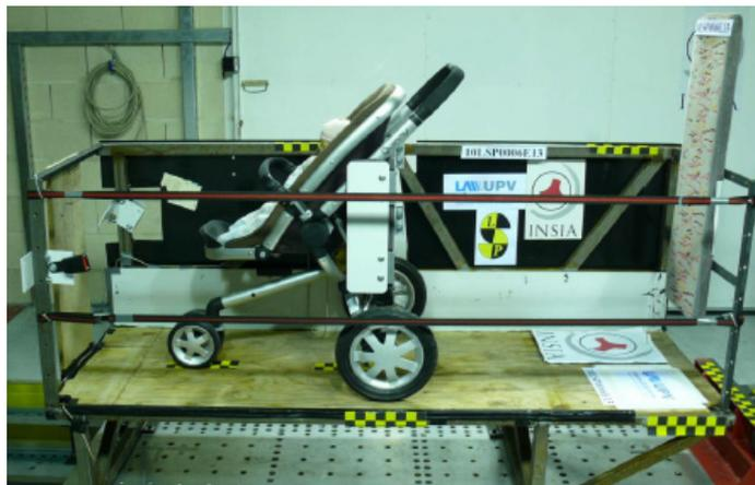
FIGURA 65. CONFIGURACIÓN PARA EL TRANSPORTE DE UN CARRITO DE NIÑO CUANDO ESTÁ DESPLEGADO EN LA ZONA 3 MEDIANTE EL USO DE SISTEMAS DE RETENCIÓN BASADOS EN MAMPARAS ABATIBLES.
