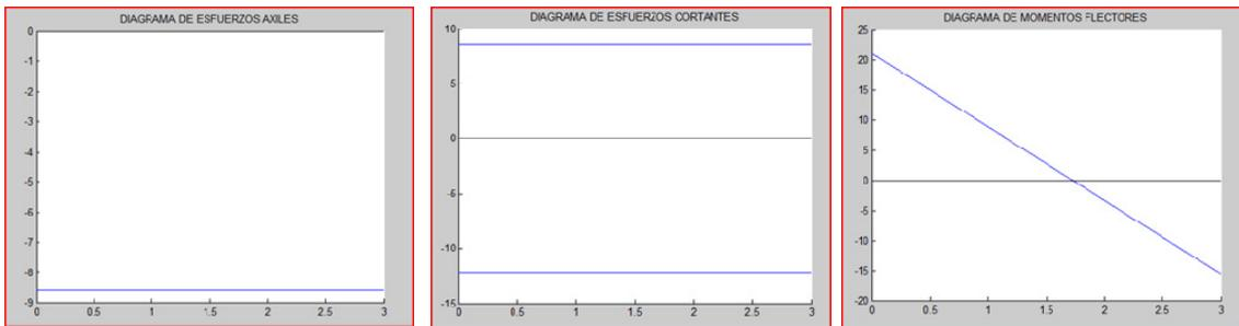
Figura 18: Diagramas de axiles, cortantes y flectores para la barra 1.
