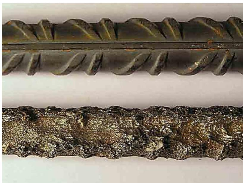
Figura 1: barras con y sin corrosión
