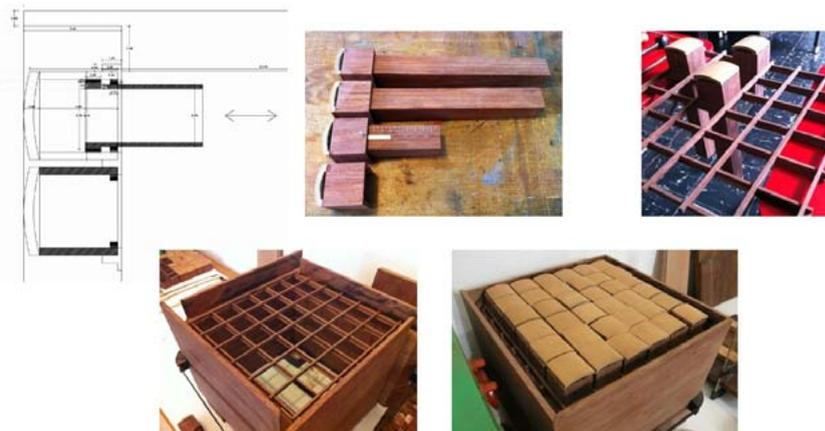
Fig. 3. Construcción de las cajas de resonancia.
