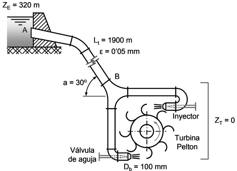
Si se suponen despreciables las pérdidas menores de la instalación, las pérdidas en cada uno de los ramales, y las pérdidas en las válvulas de aguja completamente abiertas, determinar:
