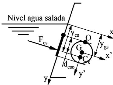
Para conocer la altura del agua dulce para la cual la compuerta empieza a abrirse, deberemos calcular primero las fuerzas hidrostáticas sobre la misma, así como sus puntos de aplicación. La fuerza sobre la compuerta debido al nivel de agua salada será:
