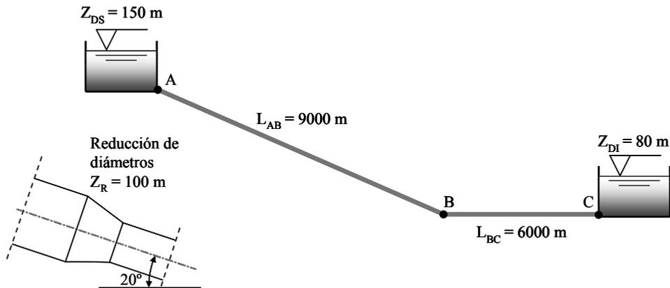
Si se desea trasvasar entre los depósitos un caudal de 600 l/s, determinar:
