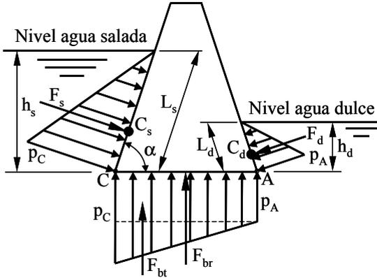
En relación con la figura adjunta, el ángulo de inclinación de las paredes del dique vale:
