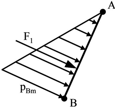
Quando el canal esté vacío, sobre la compuerta actúa un diagrama de presiones triangular debido a las acciones hidrostáticas del agua del mar. La fuerza resultante de este diagrama de presiones será:
