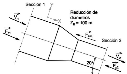
La presión en la sección de entrada se obtendrá aplicando el teorema de Bernoulli entre el nivel libre del depósito superior y dicha sección,
