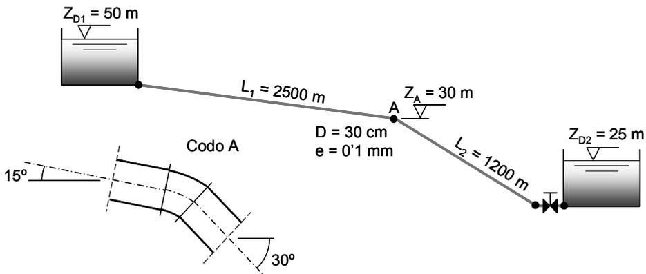
Si se suponen despreciables las pérdidas menores de la instalación, excepto en la válvula, determinar:
