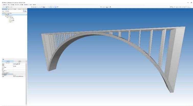
Fig. 11 Visualización del sistema estructural puente arco creado desde un visor IFC. Fuente: Elaboración propia
