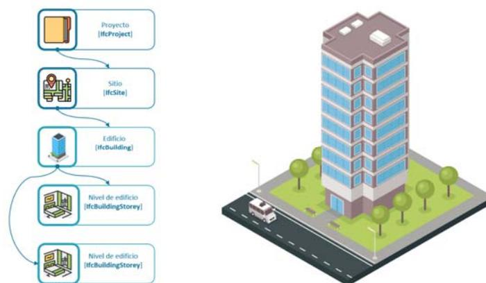
Fig.2 Ejemplo clásico de estructura espacial de un edificio según IFC 2X3
