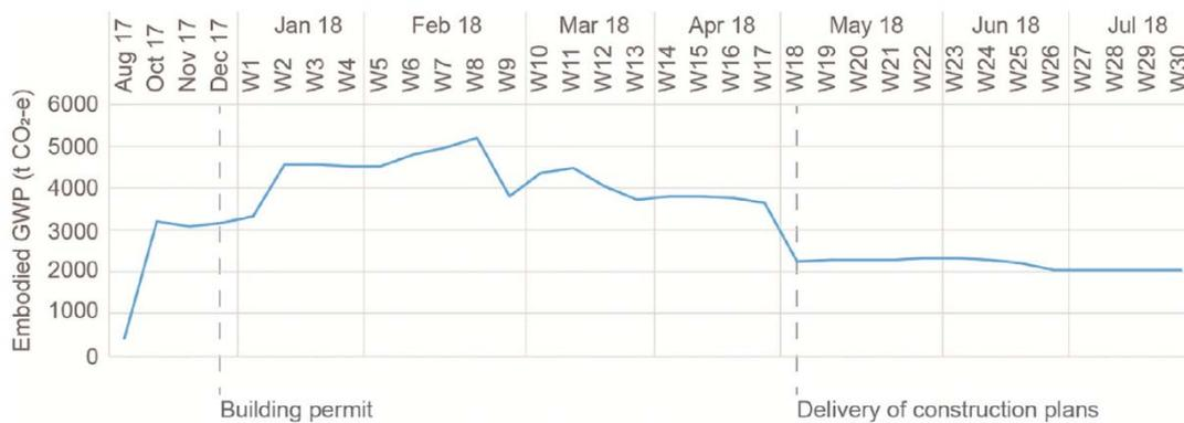
Fig. 1 Evolución de los resultados totales de la huella de carbono incorporada, expresada en GWP toneladas de CO<sub>2</sub> eq. a lo largo del proceso de diseño. Fuente: Hollberg, A. et al. (2020).
