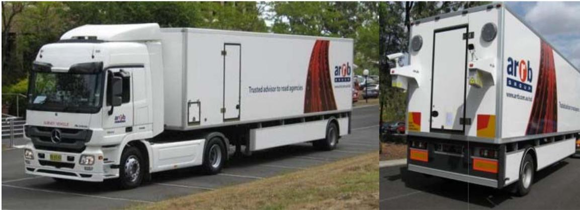
*Fig. 4 Sistema de caracterización continua IPAVE. Fuente: Flintsch, Gerardo (2023)*
