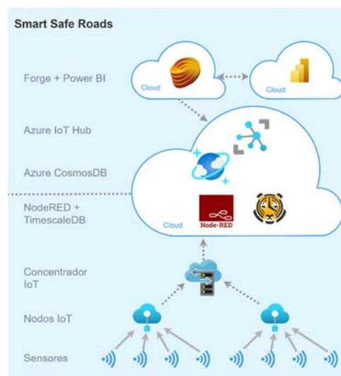
Fig. 3 Diagrama de comunicación de los datos recogidos por los sensores. Fuente: Tecnalía, plataforma TESCOR (2023)
