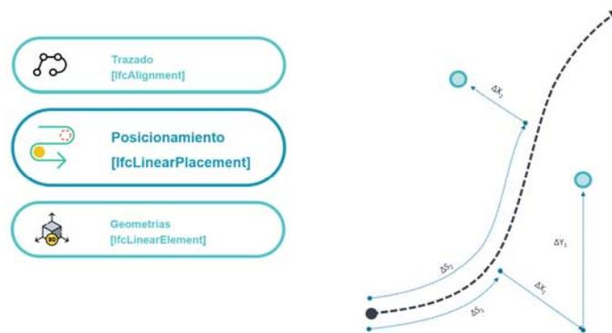
Fig.6 Posicionamiento linear respecto al Alignment
