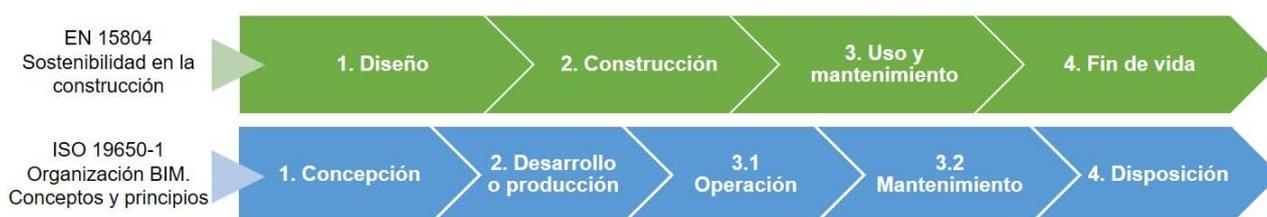
Fig. 1 Ciclo de vida de una obra de construcción (arriba) y de un activo BIM (abajo). Fuente: Elaboración propia
