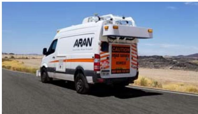
Fig. 3 Equipo ARAN desarrollado por Fugro para el análisis de carreteras. Fuente: www.fugro.com (2023)
