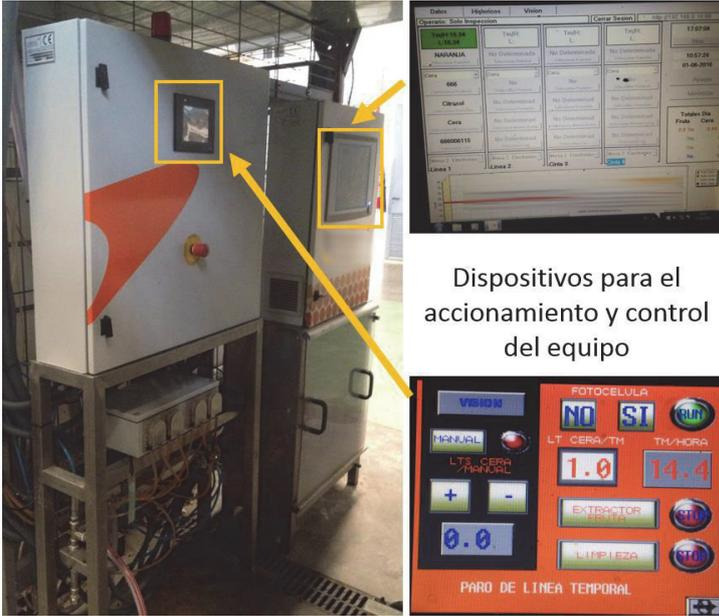
Dispositivos para el accionamiento y control del equipo
