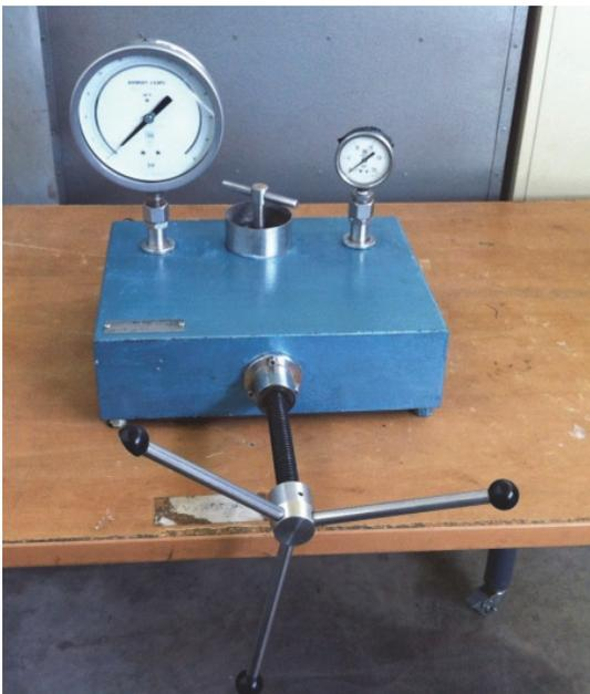
El inspector comprobará la precisión del manómetro contrastando su funcionamiento con un manómetro de referencia en un contrastador de manómetros.
