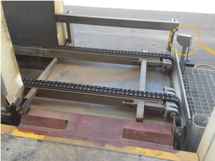
Sistema que controla el correcto posicionamiento del palet o palot en un *drencher* de cadena
