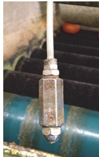
Figura 16. Boquilla de turbulencia o cono
