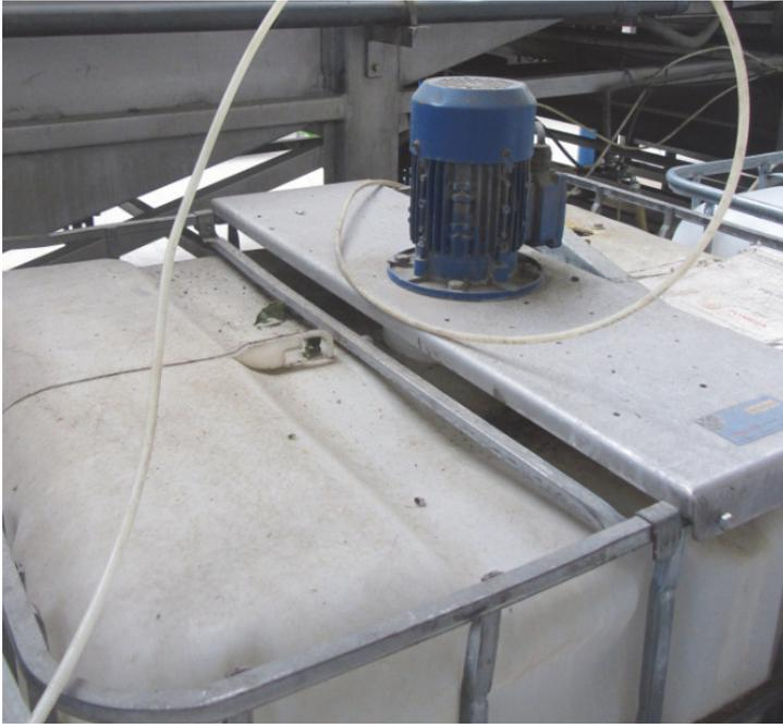
Depósito dotado de un sistema de agitación mecánico
