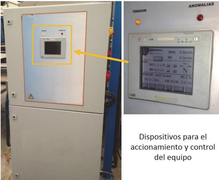
Dispositivos para el accionamiento y control del equipo
