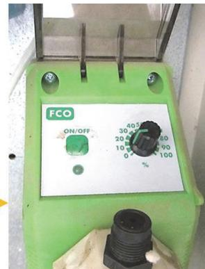
Sistema de inyección mediante el empleo de bombas dosificadoras
