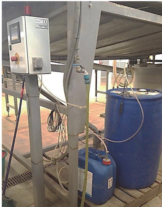
D. Ejemplo de depósito del sistema de inyección
