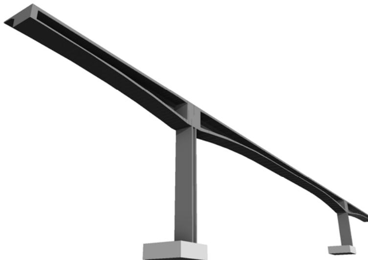
Fig 4. Vista del corte longitudinal de un puente cajón de canto variable generado con la herramienta desarrollada por Fhecor.
