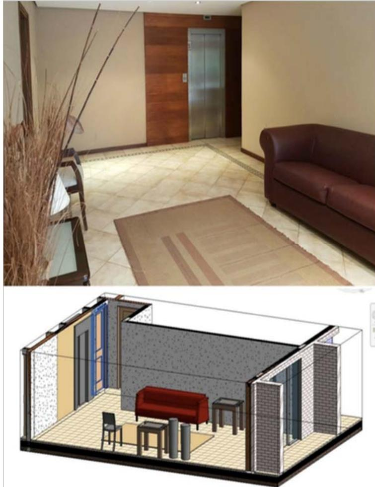
Fig. 3.- Identificación de objetos modelados con los reales, a efectos de parametrización (Elaboración propia, 2018)
