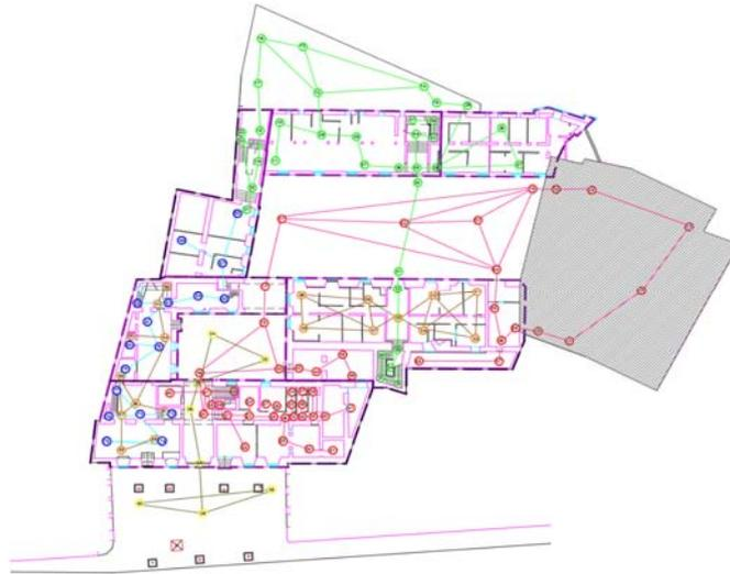
Fig. 1 Puntos de posicionamiento de escaneado
