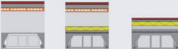
**Figura 3.** Desarrollo de la envolvente térmica en los techos a través de los años (de izquierda a derecha, antes de 1979, entre 1979 y 2006, después de 2006).
