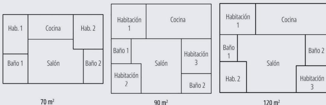
Figura 7. Planos de planta propuestos con distribución de espacios en los modelos de vivienda de 70, 90 y 120 m<sup>2</sup>.
