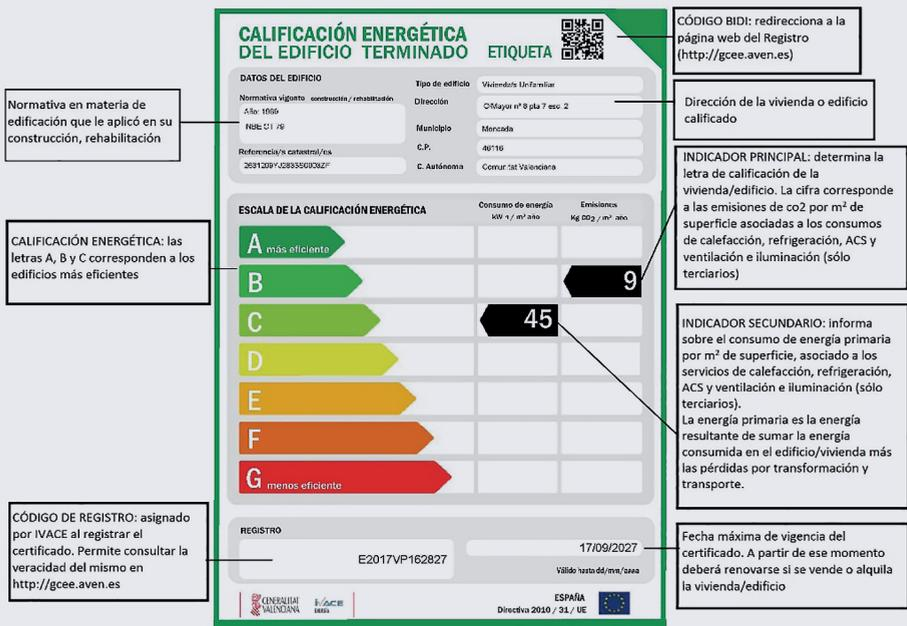
Figura 1. Etiqueta de eficiencia energética y descripción de sus elementos.
